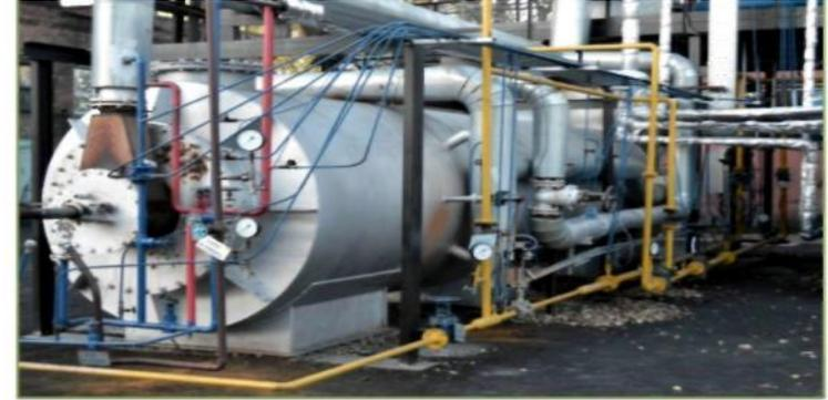
Реактор для производства электропроводного технического углерода
