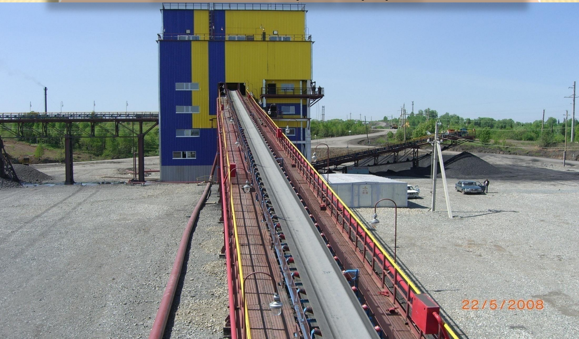
Ленточный конвейер типа КЛС производства ООО «Завод «Сибтензоприбор» в действии
