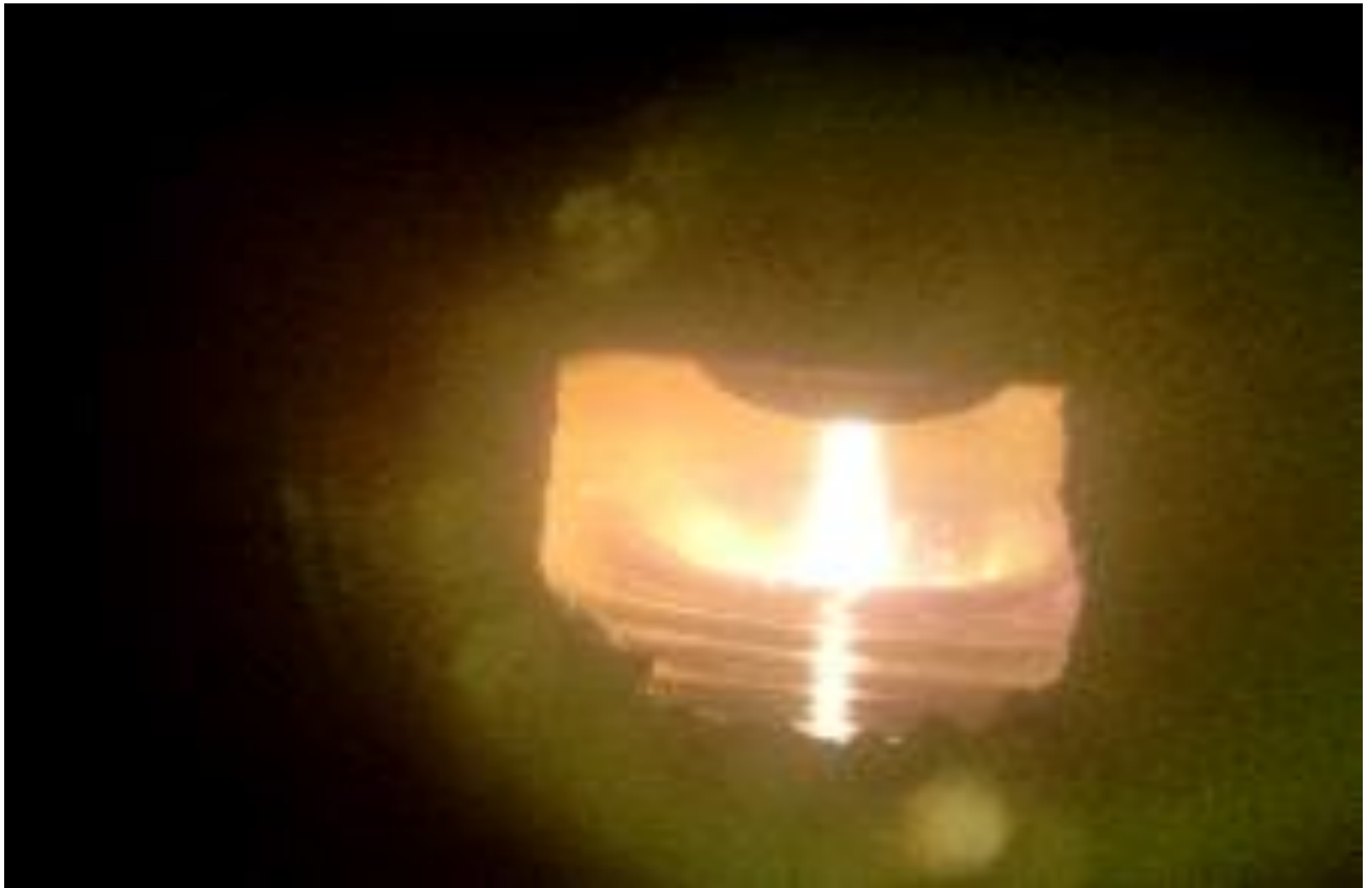
Рабочий процесс в плавильной плазменной электропечи с плазмотроном мощностью 500 кВт
