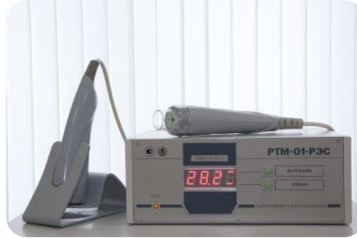
Измерение температуры коры большого полушария «РТМ-01-РЭС»
